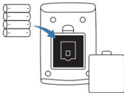
Instale las 4 pilas AA incluidas en el compartimiento de la parte posterior del dispositivo.
